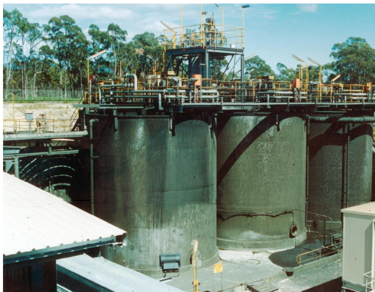
Figura 10. Ejemplo de tanques de lixiviación (foto: John Neal, Mintek).
